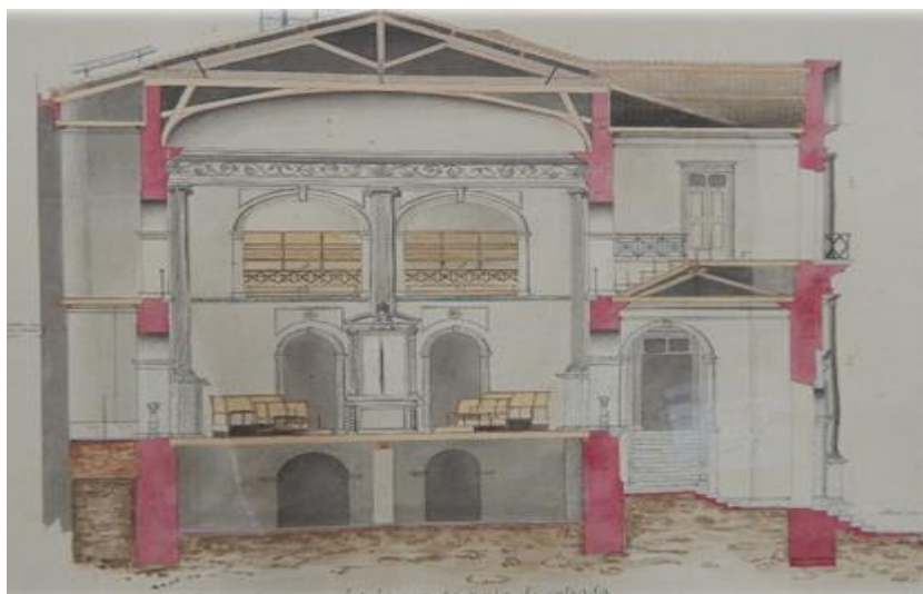
Figura 41 – Planta do TSJBA (1896): corte transversal
