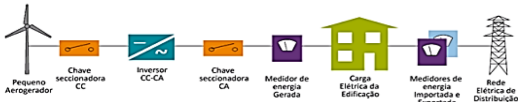
Figura 62 - Esquema simplificado de sistema eólico de pequeno porte conectado à rede.
