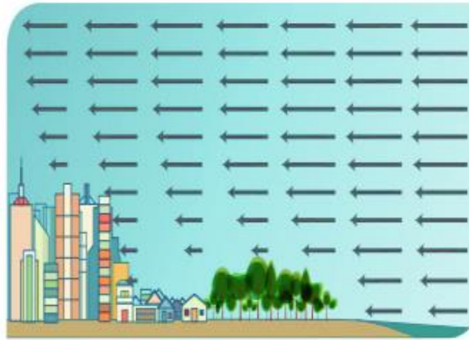
Figura 44 - Gradiente de velocidade do vento em função da altura e tipo de cobertura do solo
