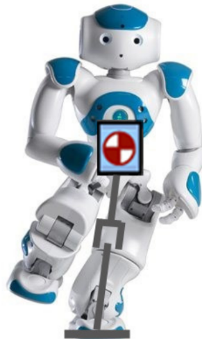
Figura 14 – O modelo do pêndulo invertido com vara telescópica aplicado ao robô NAO.
