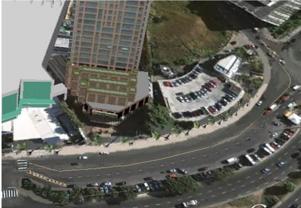
FIGURA 4.5 – REPRESENTAÇÃO DO ALARGAMENTO DA CALÇADA E DA CRIAÇÃO DA NOVA FAIXA DE CIRCULAÇÃO
