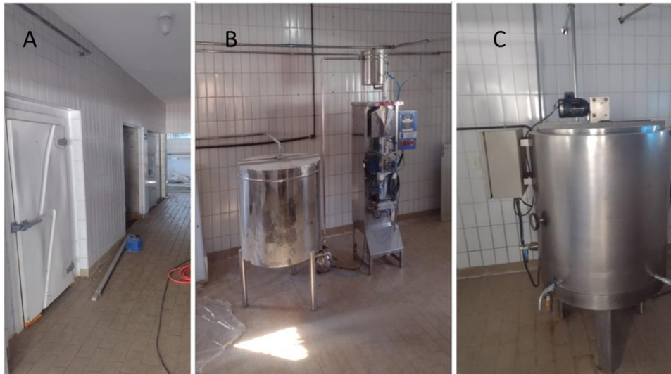
Figura 13. Infraestrutura de unidade beneficiadora de leite. A. Câmaras frias; B. Tanque resfriador; C. Pasteurizador. Fonte: Arquivo pessoal.
