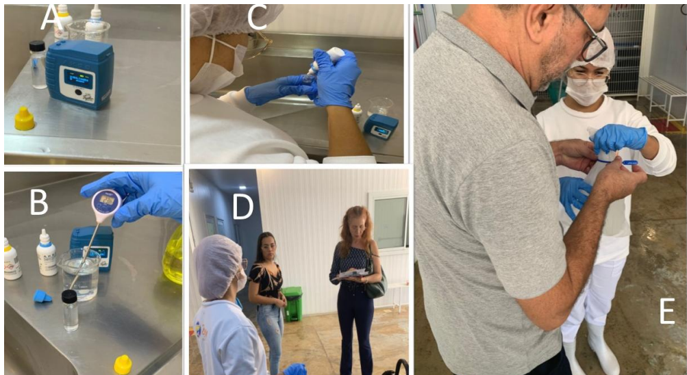
Figura 11. Coleta e análise de amostras de água. A. Medidor de cloro; B. Medidor de temperatura; C. Titulação de cloro; D. Tabulação de dados; E. Coleta e lacre da amostra. Fonte: Arquivo pessoal.
