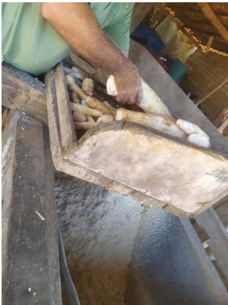
Figura 21- Cevador triturando a mandioca. Fonte: SILVA, Efigênia Rocha Barreto da, 2023.
