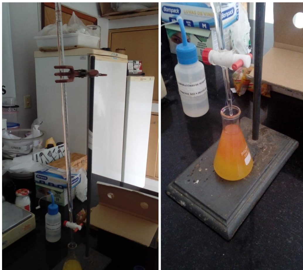
FIGURAS 04 e 05: Determinação da ATT, por meio da titulação, UNEB, Barreiras-BA, 2017.
