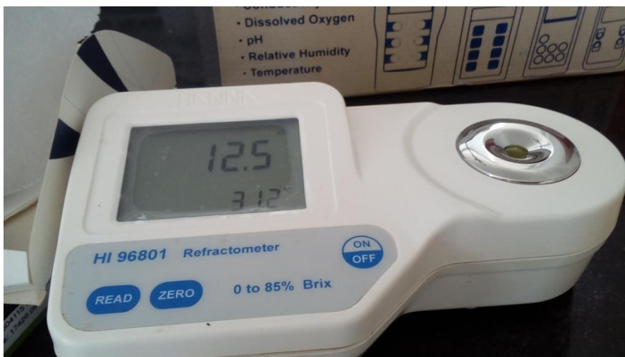
FIGURA 02. Refratômetro digital de bancada, para leitura dos sólidos solúveis. UNEB, Barreiras-BA, 2017.
