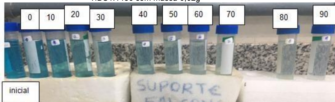
Figura 19. Alíquotas da solução de azul de metileno com composto TiBC1:1450 com massa 0,02g
