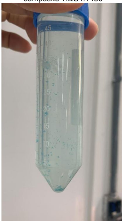
Figura 27. Descoloração do resíduo de laboratório azul de metileno com compósito TiBC1:1450
