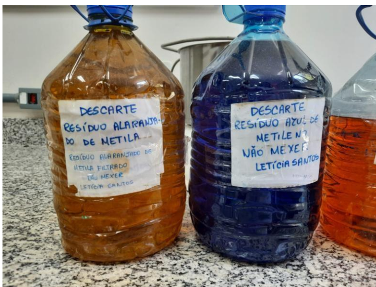
Figura 13 Ilustração dos resíduos separados e tratados para aplicação de testes fotocatalíticos
