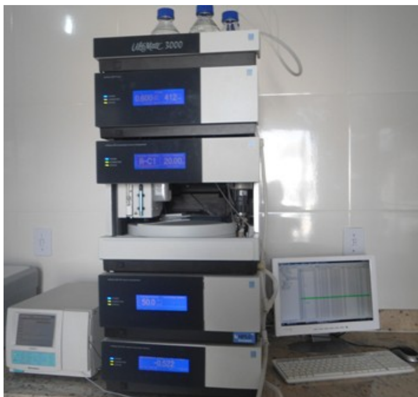
Figura 2: HPLC (Dionex, Ultimate 2000) Utilizado para análises dos produtos da fermentação da manipueira.
