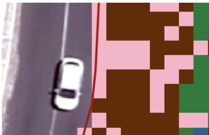
Figura 13 - Distorção de pixels no raster da ortoimagem após recorte da poligonal classificada
