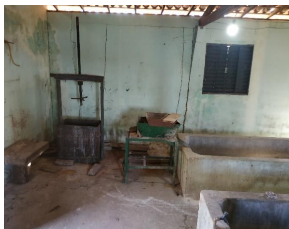
Figura 21 – Prensa utilizada para retirar a manipueira da massa da mandioca
