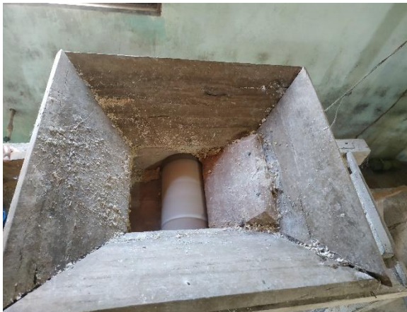
Figura 21 – Prensa utilizada para retirar a manipueira da massa da mandioca
