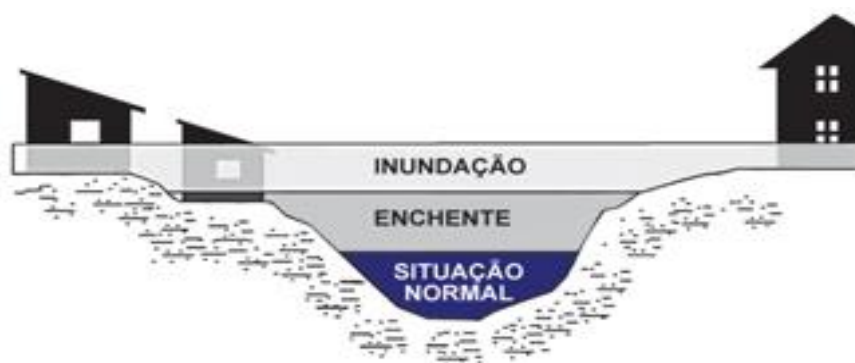
Figura 4: Perfil esquemático do processo de enchente e inundação
