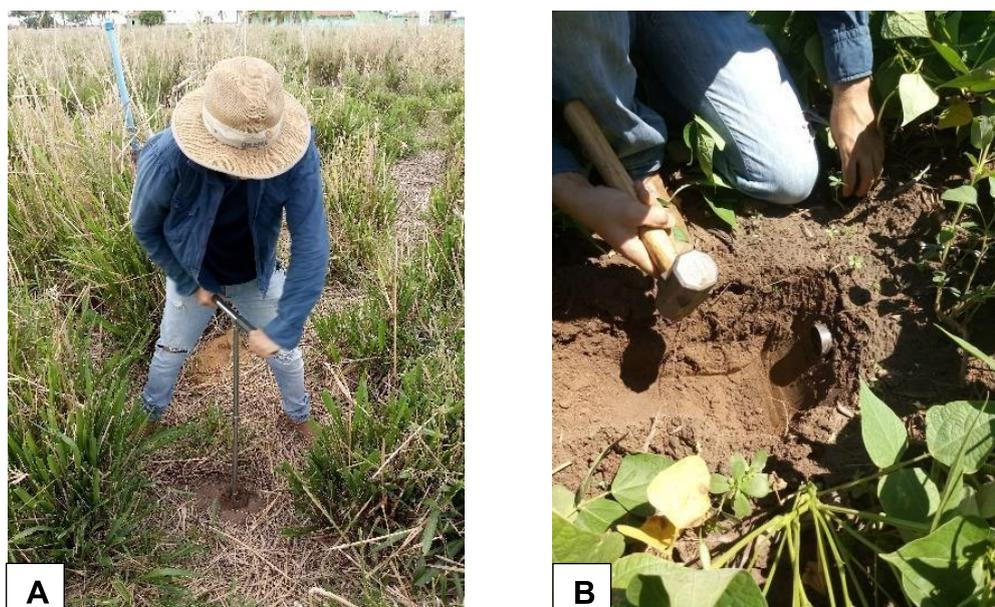
**Figura 7.** Coleta das subamostras (A) e amostras indeformadas (B). Fonte: AUTOR, 2020.
