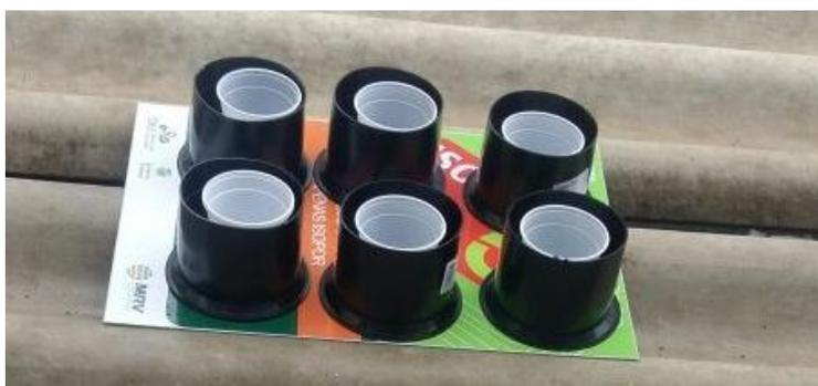
**Figura 1:** Sistema de captação para amostra laboratorial.
