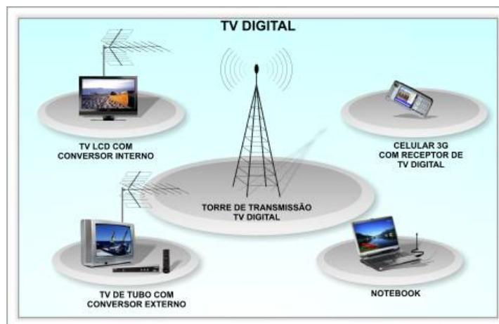
**Figura 3.4.** Um exemplo de sistema de TV Digital genérico
