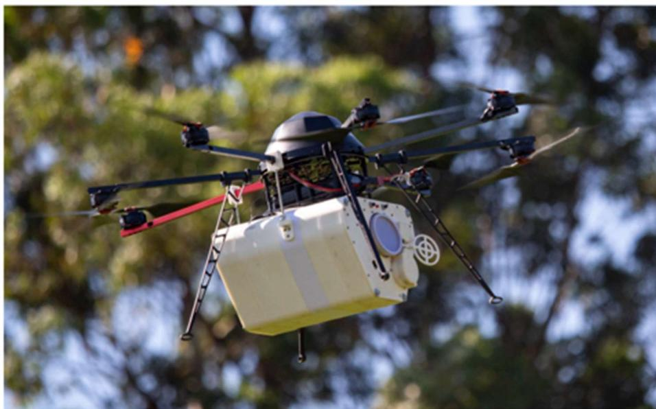
Figura 5. Mecanismo liberador de capsulas fixado no VANT. Fonte: Vieira (2020)
